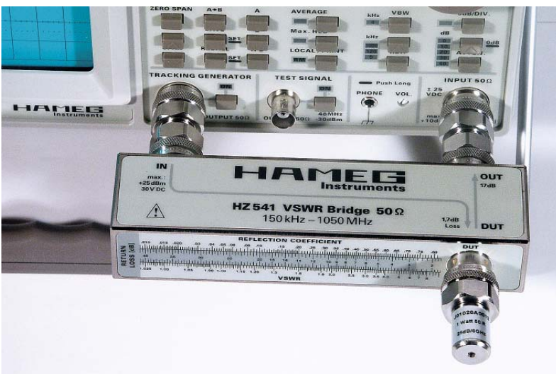
Conexión IN conectada con el generador tracking (HM 5014-2) (fuente de señal)
